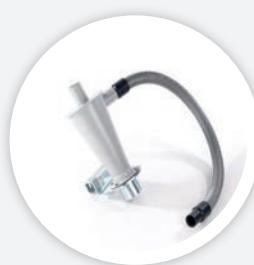
Séparation des poussières grossières par cyclone (>90% total)
