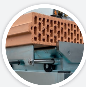
Extension de plateau télescopique pour des matériaux de plus grande taille
